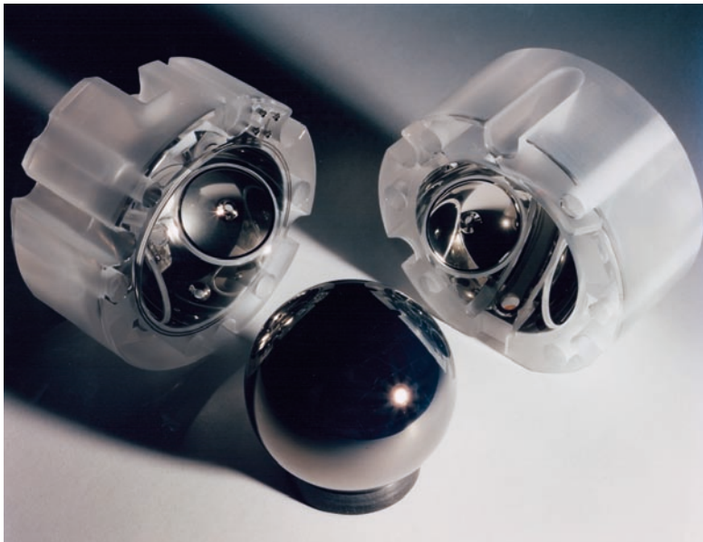
Abb. 2 Bei den Kreiseln, die in Gravity Probe B zum Einsatz gekommen sind,
