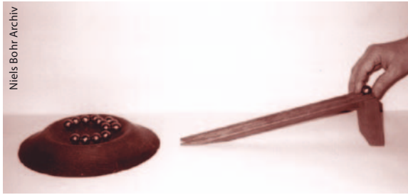
Abb. 4 Mit diesem Holzmodell verdeutlichte Niels Bohr seine Idee des Compound-Kerns. Bei der Streuung wechselwirkt das Nukleon (rechts) demnach mit vielen Nukleonen im Targetkern, die in einem Potentialtopf eingesperrt sind.
