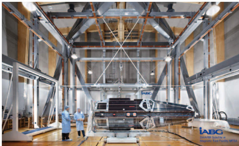
In einem speziellen Labor wurden die magnetischen Eigenschaften der SWARM-Satelliten getestet.
