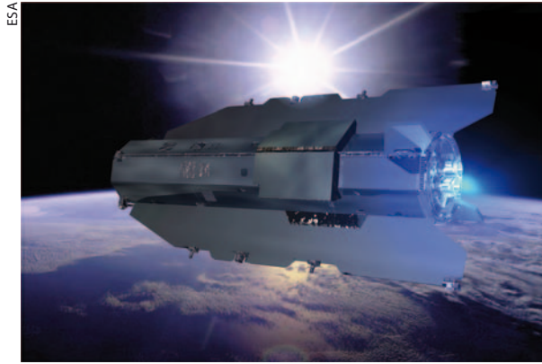
Abb. 4 Der Satellit GOCE fliegt so tief, dass es nötig ist, den Schub permanent der aktuellen Atmosphärendichte anzupassen. Das Triebwerksystem wird auf diese Weise zu einem aktiven Teil des Experiments.
