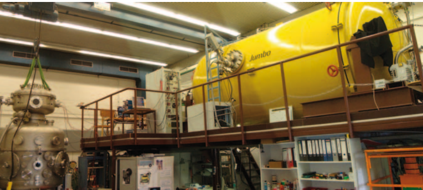
Abb. 8 Die Gießener Weltraumsimulationstanks JUMBO (rechts) und R2D2 (links) bieten Weltraumbedingungen für den Test von Ionentriebwerken.
