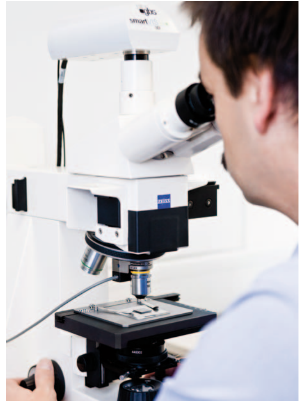
Abb. 1 Die meisten Mikroskope namhafter Hersteller lassen sich prinzipiell und relativ komplikationslos erweitern. Das Interferenzobjektiv bildet eines der zentralen Elemente der Erweiterung. Ein Tisch, der die Probe in xy -Richtung verschiebt, erlaubt es, sehr große Messbereiche einer strukturierten Oberfläche in kurzer Zeit abzuscannen.
