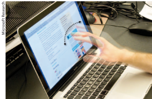
Mithilfe des Doppler-Effekts erfassen Mikrofone und Lautsprecher eines Laptops, welche Handbewegung der Nutzer macht.
