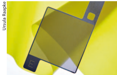
Elektroaktive Elastomer-Stapelaktoren sind recht unscheinbar: Sie bestehen aus Elektroden (vorne) und einem dielektrischen Elastomer (hinten), die abwechselnd geschichtet sind.
