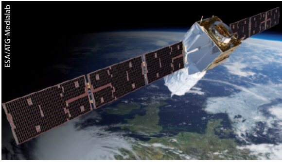
Abb. 5 Die ADM-Aeolus-Lidar-Mission wird auf einem polarumlaufenden Satelliten erstmalig Windprofile bis in Höhen von 30 km messen.
