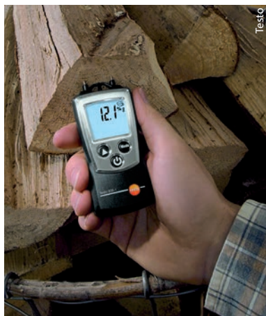
Abb. 1 Handliche Holzfeuchtemessgeräte ermitteln den Widerstand des Holzes, der stark vom Wassergehalt abhängt.
