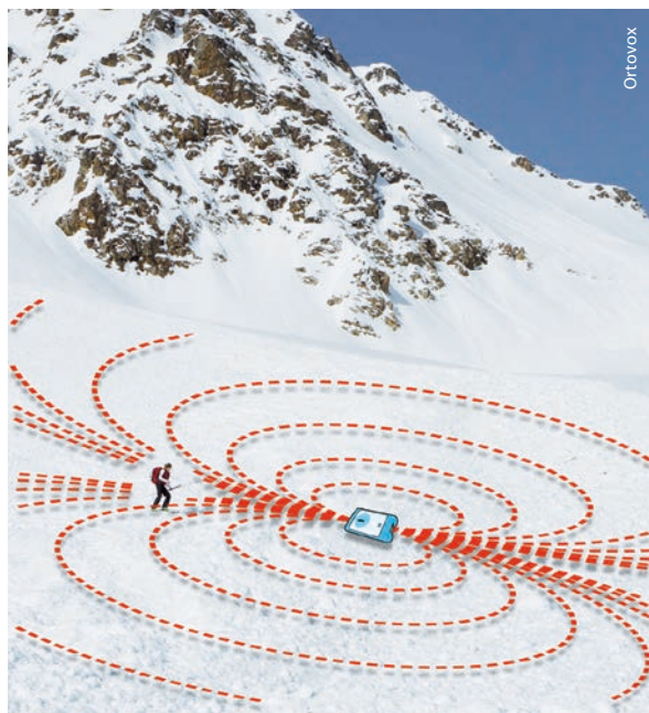
Abb. 1 Nach dem Erstkontakt weisen Pfeile auf dem LVS-Gerät den Suchenden entlang der elektrischen Feldlinien zum Verschütteten.
