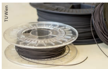
Vorverarbeitetes magnetisches Material für den 3D-Druck der Magnete
