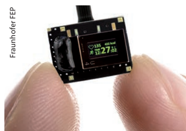
Dieses Mikrodisplay aus Dresden hat nur einen geringen Energieverbrauch.
