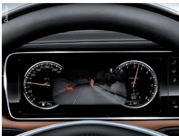
Abb. 1 Bei kombinierten Systemen werden die Informationen aus Nah- und Ferninfrarotbild in der Anzeige überlagert.
