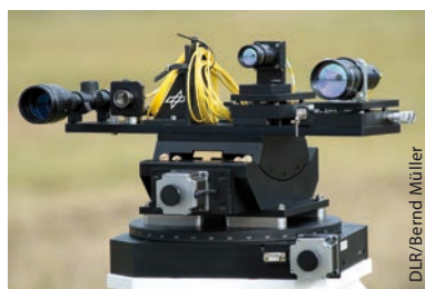
Das DLR hat das bei der Freiraumübertragung über zehn Kilometer eingesetzte Sendeterminal entwickelt.
