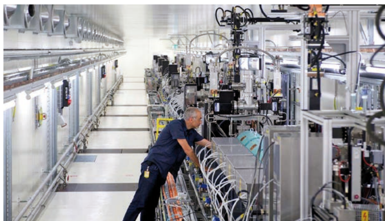
Der Injektor mit Elektronenquelle ist der erste Teil des SwissFEL-Beschleunigers.
