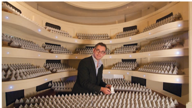
Abb. 2 Um die Auswirkung der zahlreichen kleinen Strukturen des Opernsaals auf den Klang zu untersuchen, entstand ein detailgetreues Modell im Maßstab 1:10.
